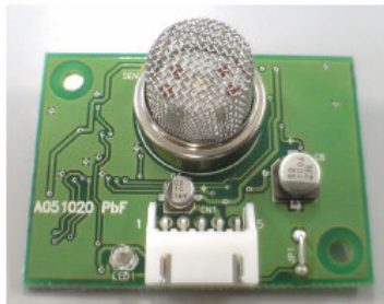
1) Ozone Sensor Module A051020-SP61-01/02
