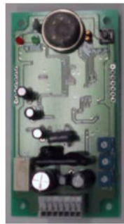
2) Ozone Sensor Module SDM-O3-05
